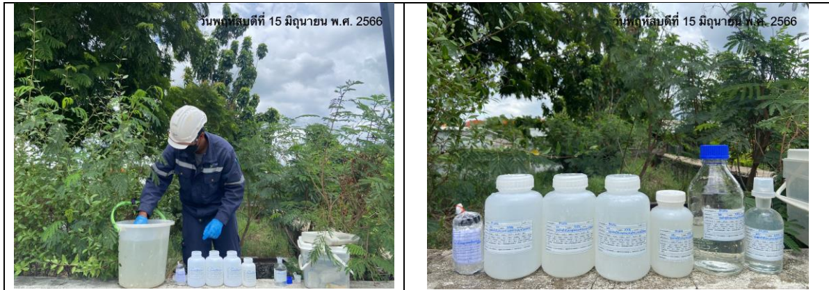
รูปที่ 3.2.1-5 ภาพถ่ายภาพเก็บตัวอย่างน้ำทั้งก่อนระบายลงสู่ท่อระบายน้ำสาธารณะ ระหว่างเดือนมกราคม-มิถุนายน 2566 (ระยะดำเนินการ)
