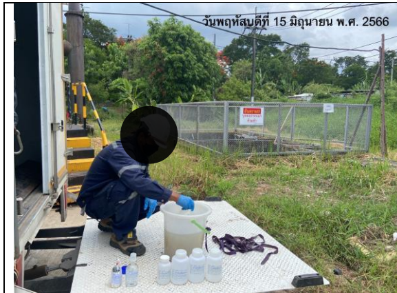
รูปที่ 3.2.1-2 ภาพถ่ายการเก็บตัวอย่างบริเวณบ่อกักน้ำเสียรวมก่อนเข้าสู่ระบบบำบัดน้ำเสีย ระหว่างเดือนมกราคม-มิถุนายน 2566 (ระยะดำเนินการ)
